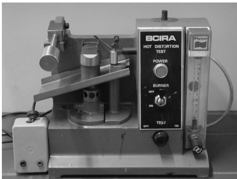
Rys. 8. Aparat BCIRA do badania parametru hot distortion [ii].
